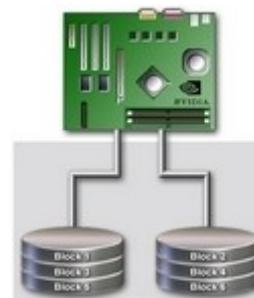
L'unité ainsi créée (grappe) a une grande tolérance aux pannes et une grande capacité d'écriture. La répartition sur plusieurs disques permet d'en augmenter la sécurité et de fiabiliser les services. Plusieurs types de configuration peuvent être mis en place avec les disques selon les besoins de l'organisation.
